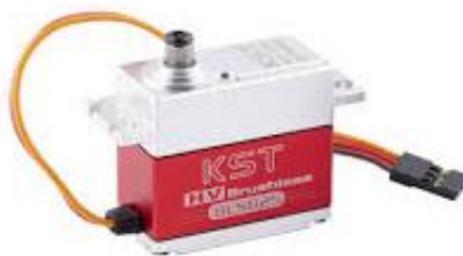
Figura 18: Servo motori KST BLS825 [5].
