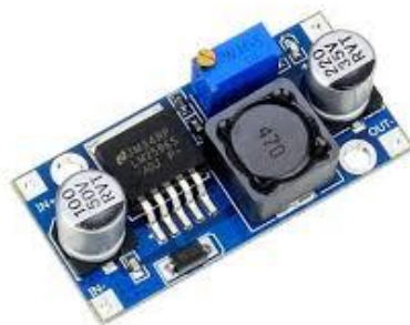
Figura 20: Konvertues DC-DC me ulje tensioni [7].
